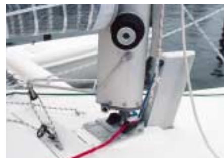
Durchbohrt: Vor dem drehbaren Mast mit Begrenzer taucht das Schwert auf
