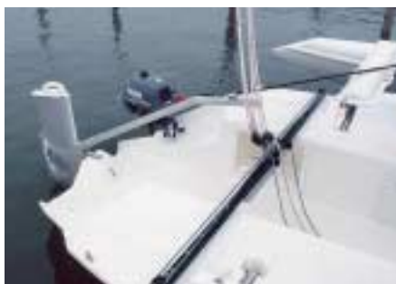
Durchdacht: aufholbares Steckruder, Schwalbennest für Außenbordertank
