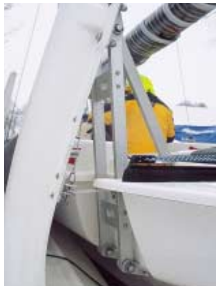
Gefaltet: Die patentierte Klappmechanik ist leicht, schnell und sicher zu bedienen
