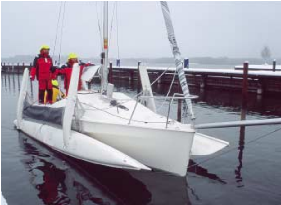
Geklappt: Sind die vier vom Cockpit aus erreichbaren Bolzen gelöst, lassen sich die Schwimmer an den Rumpf heranklappen. Perfekt für enge Boxen, Kanäle oder Transporte
